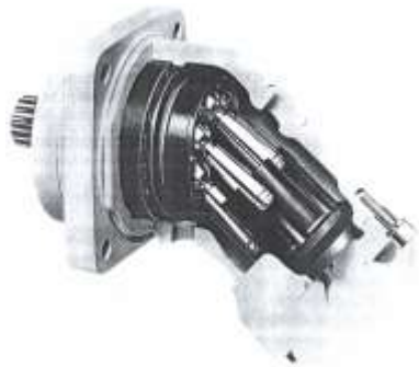
Клипно аксијалне пумпе и мотори са заокрећутним блоком - кинематика клипно аксијалне пумпе: 1 - погонско вратило; 2 – цилиндарски блок; 3 - клип; 6 – разводна плоча; 7 – потисни канал разводне плоче; 8 – усисни канал разводне плоче.
