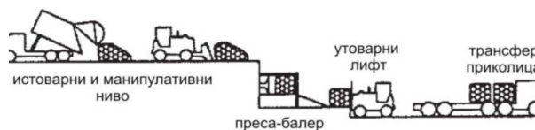
д) Претоварна станица са балер системом
