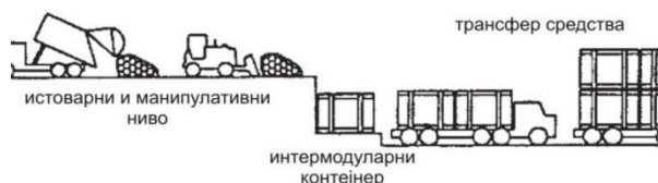
е) претоварна станица са интермодуларним контејнерима
