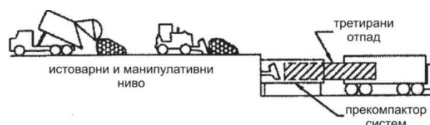
г) Претоварна станица са прекомпактором
