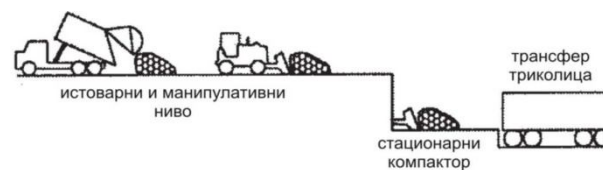
в) Претоварна станица са стационарним компактором
